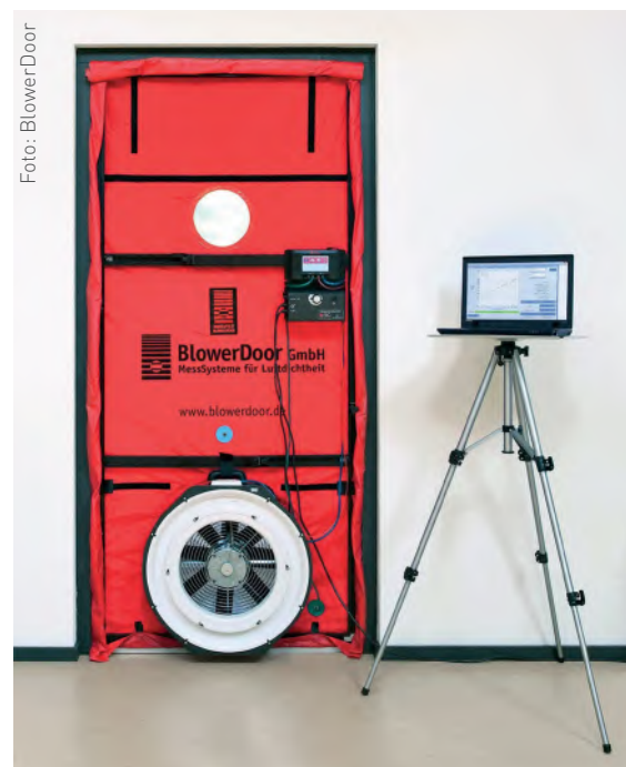
Die Luftdichtheit wird mittels BlowerDoor-Messung überprüft.
