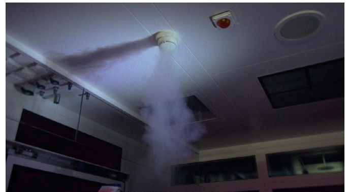
Bild 3. Visualisierung des Leckluftvolumenstroms an einem Rauchmelder (Fotos/Grafik: STZ EURO Steinbeis-Transferzentrum)
