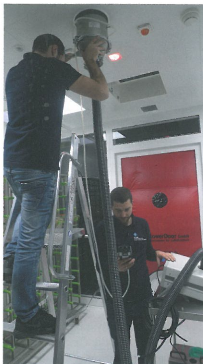
Bild 1. Prüfung Leckluftvolumenstrom an Einzelkomponente
